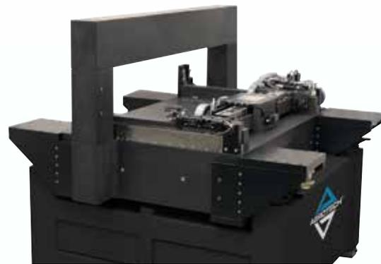
ABL9000運動平台帶有花崗岩橋接/Z軸，優化的隔離系統與機器底座
