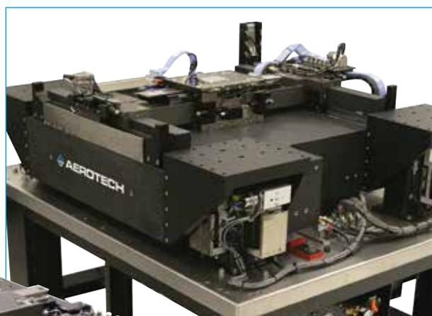
ABL9000平面空氣軸承帶有客製化隔離系統
