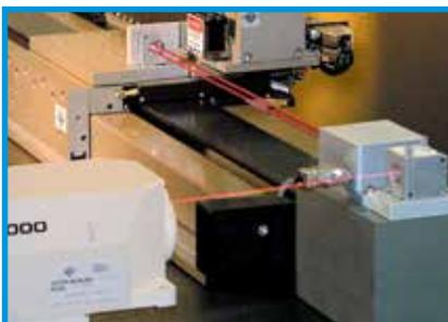
系統需要超高精度和回饋穩定性時，可以用雷射干涉儀做回饋
