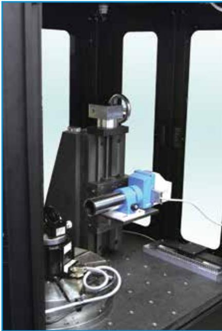
Aerotech旋轉校正器(ARC)為角度和旋轉台校準的性能設定了一個新的業界標準。校正器的重心是一個擁有奈米級誤差運動性能的大型旋轉空氣軸承軸。這個擁有高精度的空氣軸承主軸是由鋼建造而成，能夠與周圍花崗岩
